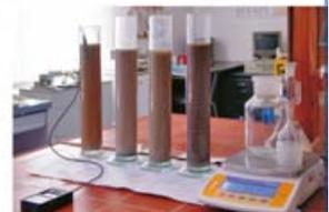
Bestimmung der Korngrößenverteilung durch Sedimentation nach DIN EN ISO 17892-4
