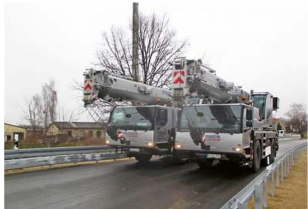
Bild 9: Belastungsversuch nach Fertigstellung
