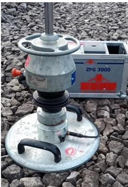
Bei einem SGS Einbau ist es sinnvoll auf der SGS Schicht einen EVd Wert von 25 MN/m<sup>2</sup> mit der dynamischen Fallplatte nachzuweisen. Auf jeden Fall sollte der der EVd von 20 MN/m<sup>3</sup> nicht unterschritten werden!
