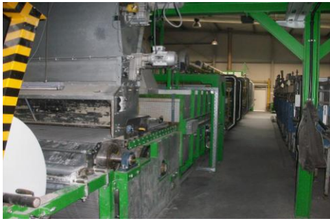
Aufgeben des Glasmehls am Tunnelofen
