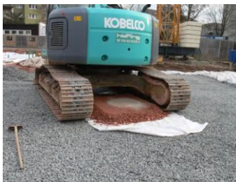
Nachweis der erreichten Steifigkeit durch statische und dynamische Lastplatte
