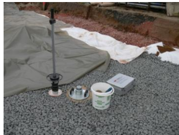
Nachweis der erreichten Steifigkeit durch statische und dynamische Lastplatte
