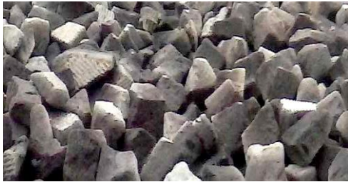
Brechen der SGS Brocken zur Schüttung
