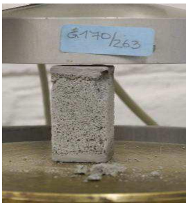
Axiale Druckfestigkeit 1500 – 4000 KN/m 2
